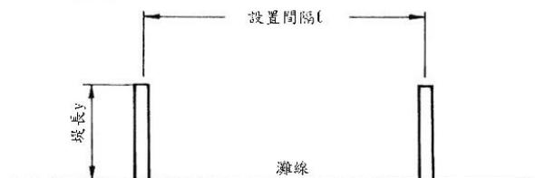
設置單一突堤，突堤漂砂上游側灘線前進，下游側灘線後退現象極明確，原則上必要如下圖，設置堤群以維持計畫灘線，對沿岸漂砂卓越方向隨季節而異時，應檢討各方向的灘線變化。
