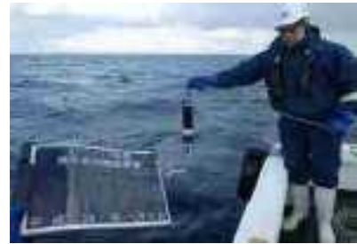
水中音速度測定(補正用データ取得)
