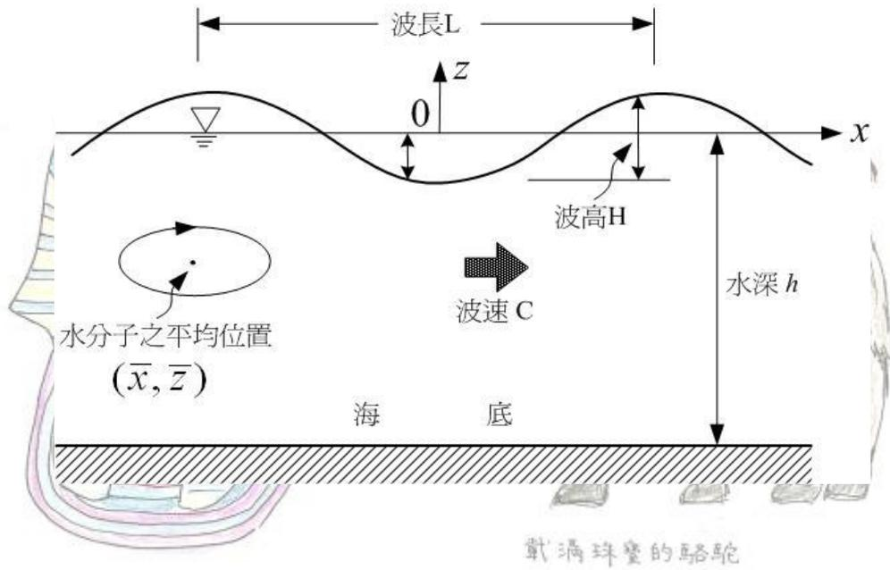
如圖所示，最高水位處稱為波峰(Wave crest)，最低水位處稱為波谷，波峰與波峰間或波谷與波谷間的距離稱為波長(Wave length)，通常以  $L$  表示。
