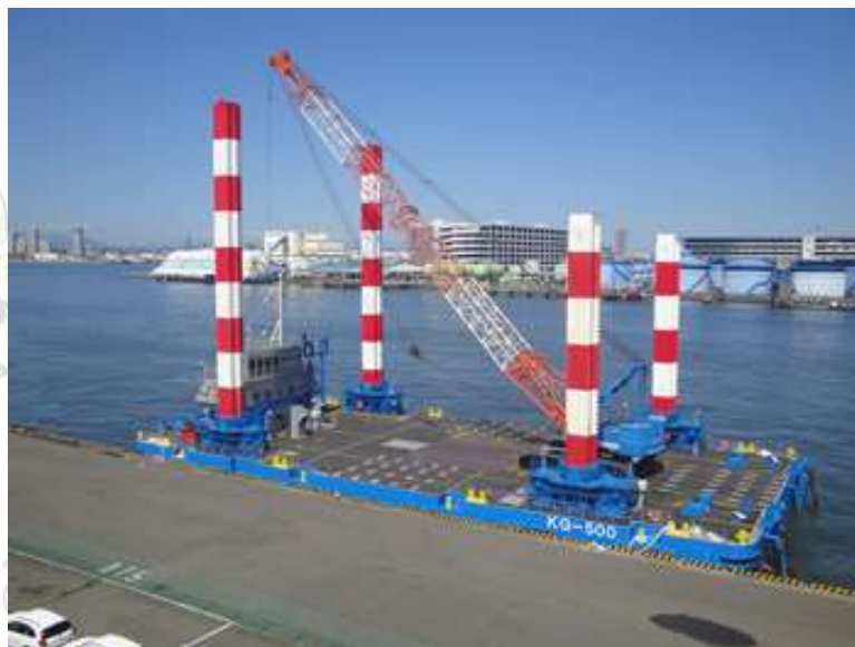
多目的棒錨駁船「KG-500」海洋技術建設株式会社 所有
