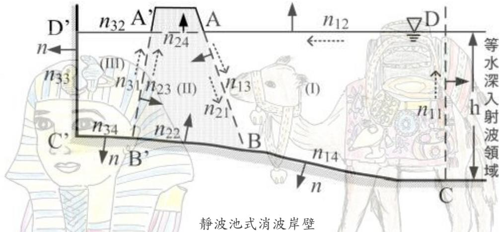
如上圖，不透水岸壁前設置靜波池式消波堤，與透水式防波堤的開放領域內設置透水式防波堤的不同條件，僅為將等水深透過波領域假想邊界線變成不透水岸壁，其他邊界條件均相同，即令  $\bar{\phi}_3^3=0$  即可。
