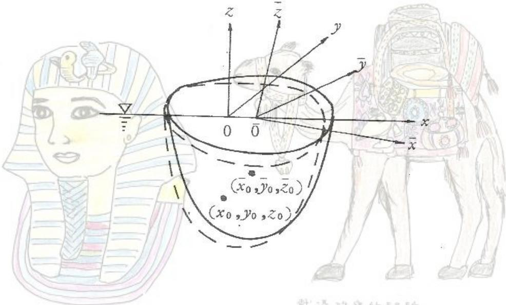
如上圖，在水面附近有浮式結構物(floating body)存在，受波浪作用時浮體之運動可分為  $x$ 、 $y$ 、 $z$  方向直線運動水平移(surge)、橫移(sway)、垂直移(heave)及對  $x$ 、 $y$ 、 $z$  軸回轉運動橫轉(roll)、縱轉(pitch)、平轉(yaw)等 6 種運動，由於自由度有 6 度，故解析浮體運動時必須解 6 元 樣 次聯立方程式。
