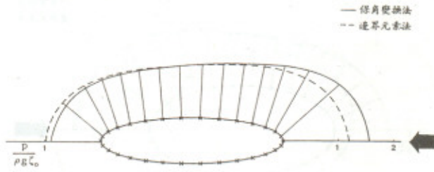
圖5. b/a = 0.25 , a/h = 1.0 , \sigma^2 h/g = 1.0 , kh = 1.2 時橢圓形斷面波壓分佈圖
