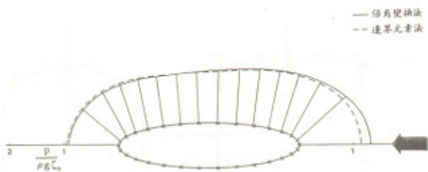
圖4 b/a = 0.25 , a/h = 1.0 , \sigma^2 h/g = 0.5 , kh = 0.772 時橢圓形斷面波壓分佈圖
